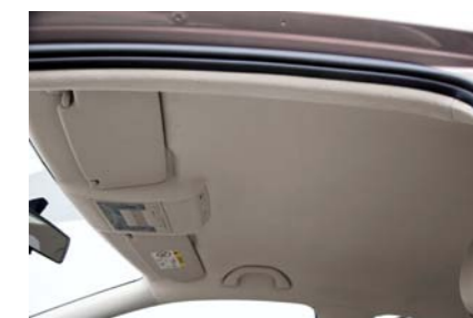
Мягкая обивка потолка, знакомая по автомобилям Skoda Octavia, может снизить уровень шума в салоне еще на 0,5–1 дБ
