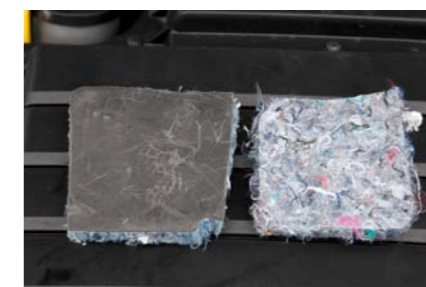
Усиленная шумоизоляция моторного щита: раньше был только слой войлока (на фото справа), а теперь он на прорезиненной основе (слева), что дает снижение шума в салоне на 1–2 дБ
