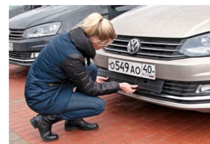
Мария Кох занимается адаптацией машин к российскому рынку — и сейчас демонстрирует легкосъемную пластиковую заглушку для нижней части бампера: она появится на всех Polo с 16 ноября — для защиты радиатора от грязи в зимнее время
