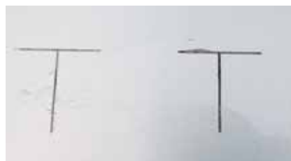
...но даже в самых глубоких тарированных надрезах лакокрасочного покрытия (на фото — справа) — только белесые следы окислившегося цинка
