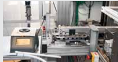
Отличительная черта оборудования в центре ANAC — не требующий вмешательства людей автоматизированный ленточный конвейер, по которому движутся образцы масел. Дело поставлено на поток: за год лаборатория производит 180 тысяч анализов
