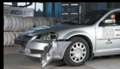
Volga Siber (АР №23, 2009). Повреждены фара, капот и его петли, панель радиатора и радиатор, бампер, решетка радиатора, деформировались передний брус, лонжерон и чашка подвески
