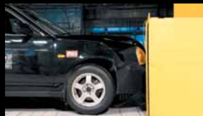
Лада Приора (АР №5, 2009). При ударе на скорости 15 км/ч пострадал капот, крыло, фара, бампер, погнулись лонжерон и усилитель бампера. Повреждения также получили опоры двигателя и кронштейн рычага подвески, а привод колеса вырвало из коробки передач
