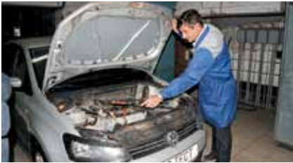
Из-за того что в зону деформации попала выштамповка ребра жесткости, в официальных сервисах за ремонт капота не взялись
