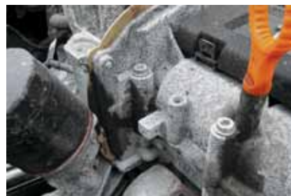
Двигатель потеет маслом через прокладку передней крышки
