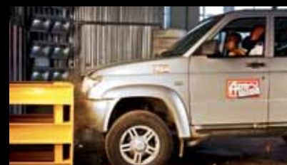
УАЗ Патриот (АР №22, 2010). Деформировались лонжерон рамы и места крепления кузова к раме. Повреждены бампер и его усилители и кронштейны, крыло, фара, подфарная накладка, передняя панель, кронштейны вентиляторов системы охлаждения, брызговик моторного отсека, опора крепления силового агрегата
