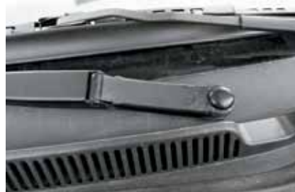
Десятки часов пребывания в коррозионной камере обезобразили поводки стеклоочистителей...
