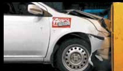
Geely МК (АР №9, 2009). Сильно смялся капот, повреждены крыло, верхняя панель радиатора, сам радиатор, бампер с усилителем, лонжерон и фара
