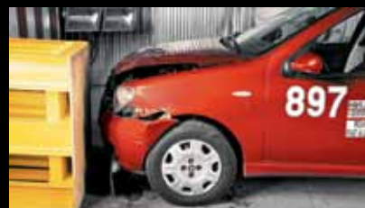
Fiat Albea (АР №21, 2009). Пострадали капот, бампер, обе фары, опоры силового агрегата, радиатор и конденсатор кондиционера, лонжерон, усилитель бампера, полка радиатора со стойками
