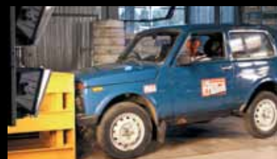
Лада 4x4 (АР №18, 2010). Пострадал бампер и сминаемый кронштейн его крепления. Чуть погнулись рамка радиатора, передняя панель, передняя часть брызговика моторного отсека, левое крыло и нефункциональные торцы лонжеронов
