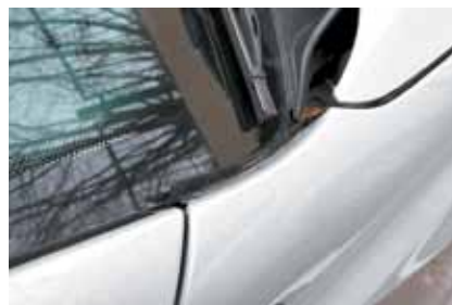
От верхних кромок передних крыльев отклеились пластинки водоотводов
