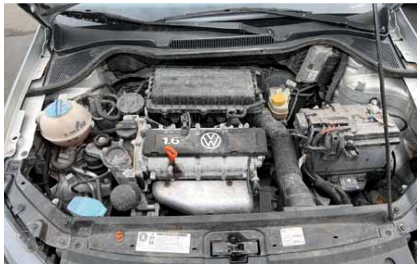
Моторный отсек практически не изолирован от попадания грязи. Но ни это, ни пребывание с открытым капотом в коррозионной камере не сказалось на работе электрики и навесного оборудования двигателя
