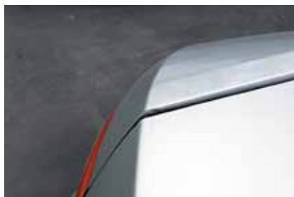
Крышка багажника просела по отношению к уровню задних крыльев.
